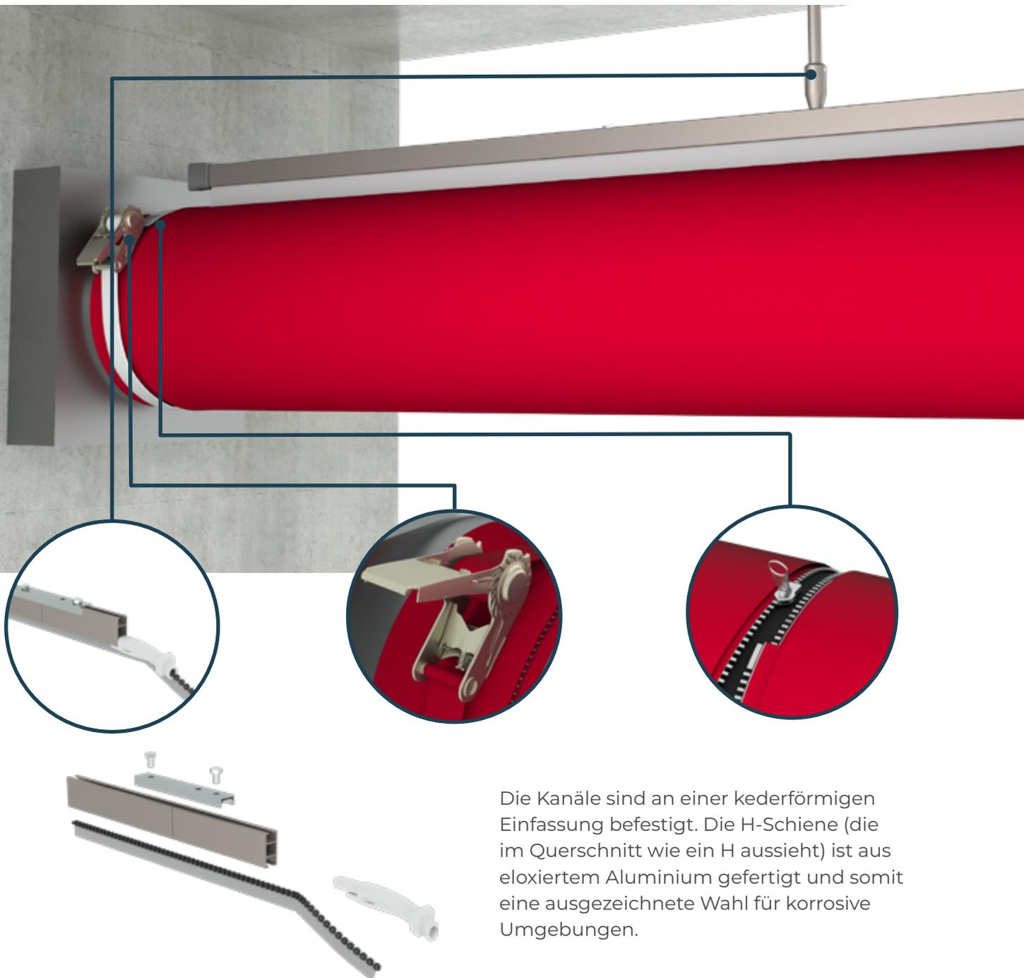
Die Kanäle sind an einer kederförmigen Einfassung befestigt. Die H-Schiene (die im Querschnitt wie ein H aussieht) ist aus eloxiertem Aluminium gefertigt und somit eine ausgezeichnete Wahl für korrosive Umgebungen.
