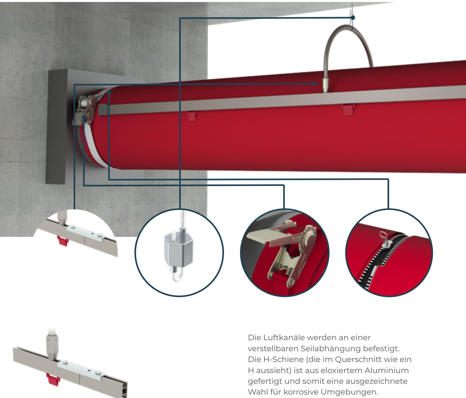
Die Luftkanäle werden an einer verstellbaren Seilabhängung befestigt. Die H-Schiene (die im Querschnitt wie ein H aussieht) ist aus eloxiertem Aluminium gefertigt und somit eine ausgezeichnete Wahl für korrosive Umgebungen.
